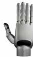
Linker Hand L10是一款具备10个自由度的高性能灵巧手,采用连杆传动方式与自研电机驱动,在提升牵引稳定性的同时,实现精准控制与运动表现。
